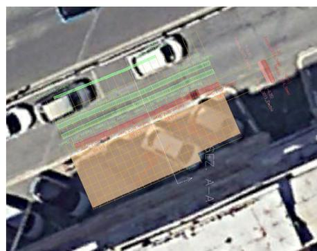
Le sezioni radar rappresentano i risultati delle indagini. L'asse orizzontale riproduce la direzione di avanzamento dell'antenna al di sopra del mezzo investigato, mentre l'asse verticale rappresenta la direzione di penetrazione degli impulsi. Dall'interpretazione dei dati radar georeferenziati viene eseguita la mappatura delle anomalie riportate sulla planimetria da Voi fornita.
